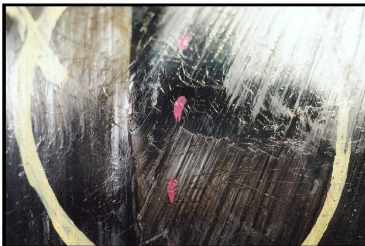
شکل ۶۹- آسیب ناشی از ضربه وارده به یک نوع مخزن کامپوزیت
