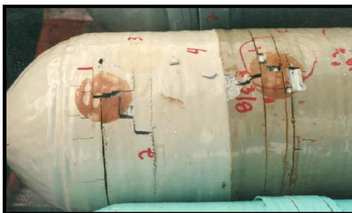
شکل ۷۰- آسیب ناشی از اثر اسید بر روی یک نوع مخزن کامپوزیت
