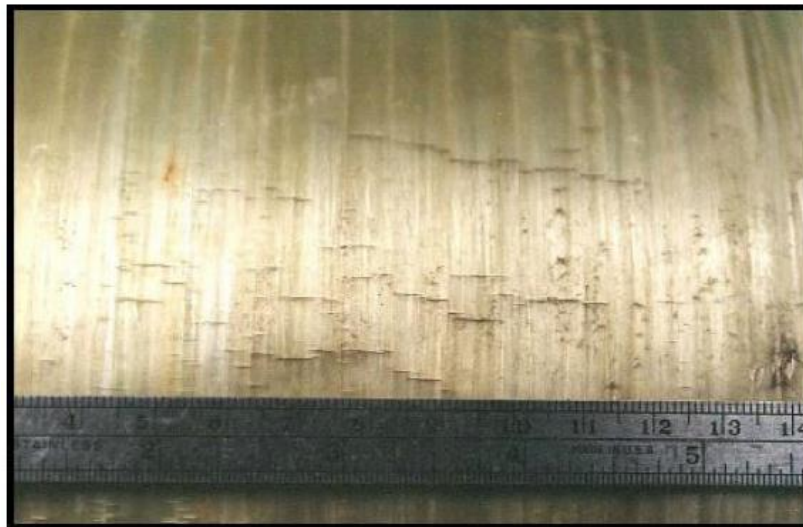
شکل ۷۸- آسیب SCC به وجود آمده در یک مخزن کامپوزیت
