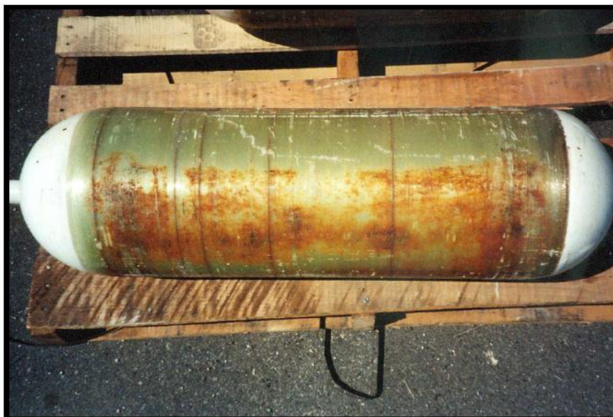
شکل ۷۴- یک نمونه خوردگی به وجود آمده در زیر بخش کامپوزیت یک مخزن نوع CNG-2
