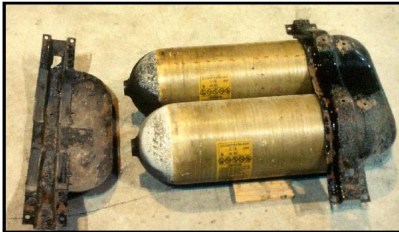
شکل ۷۵- یک نمونه خوردگی گالوانیکی به وجود آمده در یک مخزن نوع CNG-2
