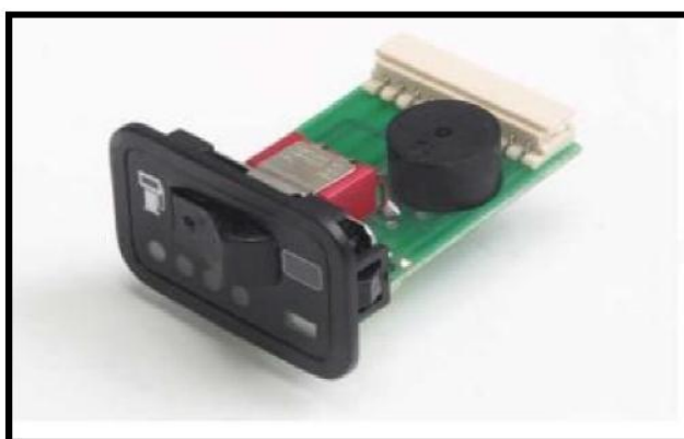
شکل ۵۹- قطعات داخلی یک نمونه کلید تبدیل سوخت
