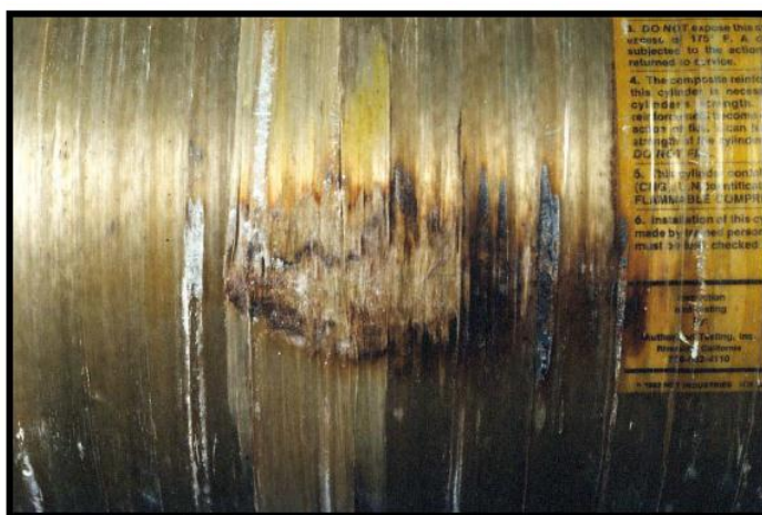
شکل ۷۱- آسیب ناشی از وقوع یک آتش سوزی و در نتیجه سوختن سطح یک نوع مخزن کامپوزیت
