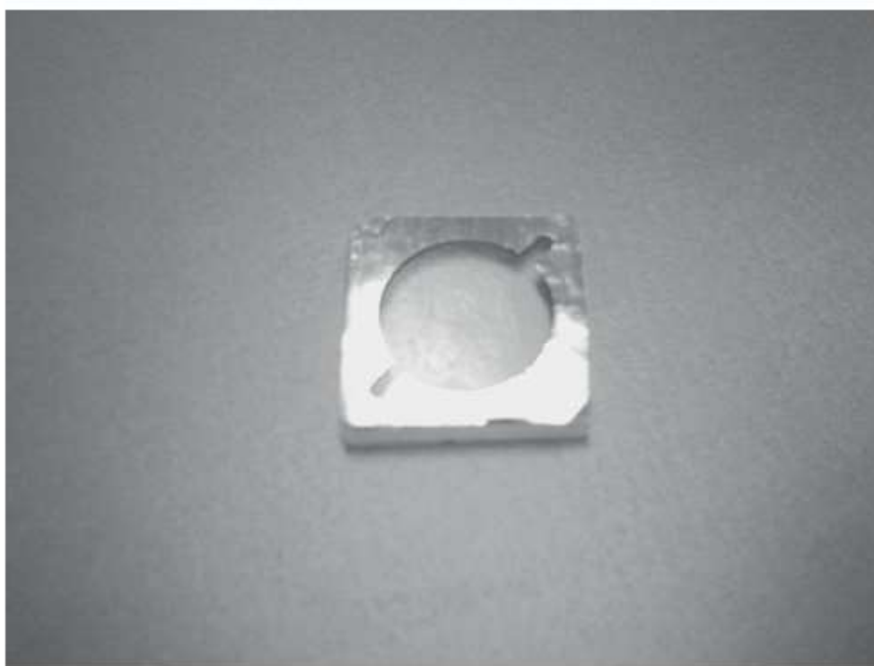
شکل الف-۲-۲- فاصله‌گذار قرار گرفته روی صفحه KBr
