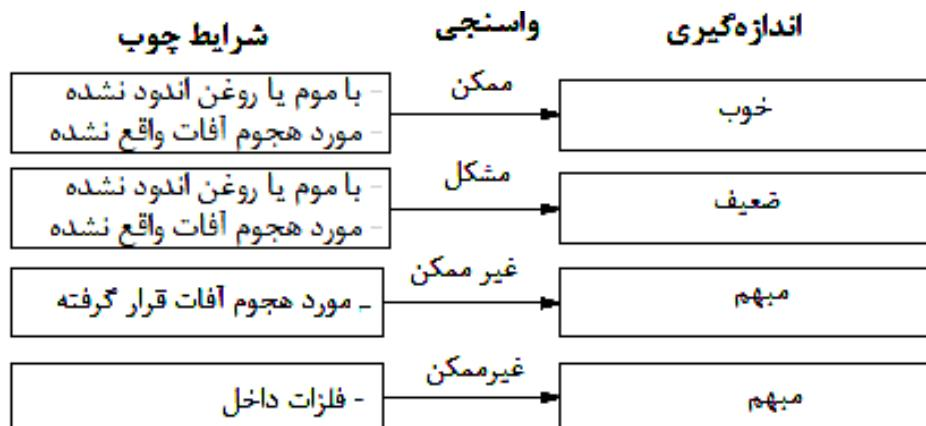
شکل ب-۲- امکان انجام یک واسنجی قابل اعتماد و کیفیت اندازه‌گیری‌های خاصل از روش‌های مقاومتی یا خازنی در چوب. اعداد داخل پرانتزها به شماره‌های بندها اشاره دارند.
