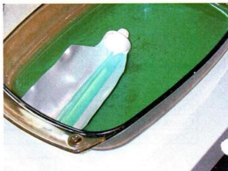
شکل الف-۱- تیوب درون ظرف حاوی محلول سولفات مس
