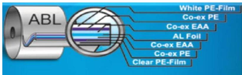
شکل ۸- تصویر از ورق چندلایه با لایه ممانعت کننده آلومینیوم
