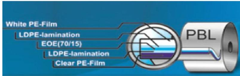
شکل ۹- تصویری از ورق چندلایه با لایه ممانعت کننده پلیمری
